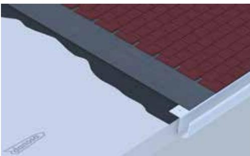
**CUBIERTA INCLINADA CON PLACA ASFÁLTICA**
