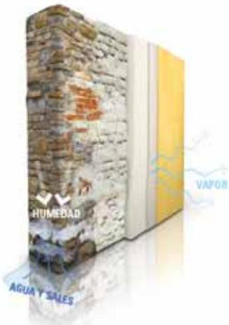
La dimensión de los **MICROPOROS ACTIVOS** de **Bioalce®MuroSeco** garantiza una elevada transpirabilidad y una bajísima absorción capilar. El diámetro reducido de los canales capilares bloquea el paso de agua, que no entra en el enfoscado y permite el libre paso de las moléculas de vapor.
